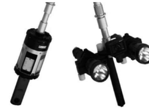
マンホール点検用の管 診鏡MCと管口点 検用のPC
