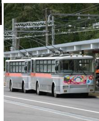
写真11 関電トンネル無軌条電車(トロリーバス 2019年度より電気バスになる)
